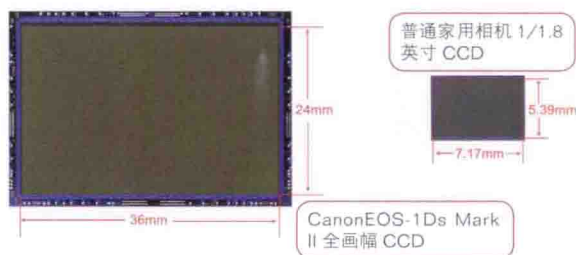
▲ 单反数码相机与家用级数码相机 CCD 面积对比
