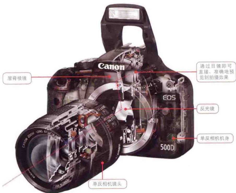
▲ Canon 数码单反相机内部结构和工作原理
