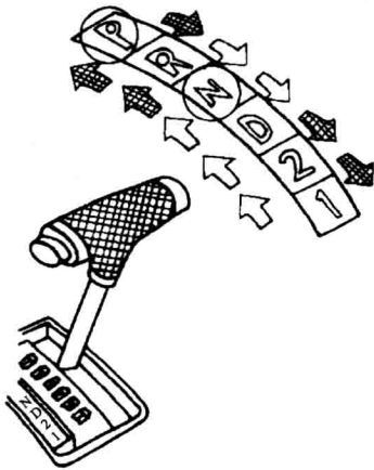
图2-8 换挡操纵手柄示意图
