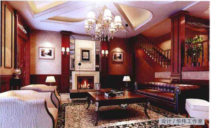
饰面板实木线外刷金漆边口装饰 石膏板造型天花
