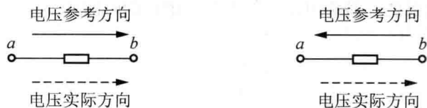
(a) 电压参考方向与实际方向相同
