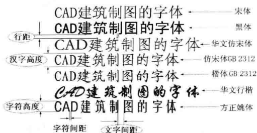
图 1.8 城乡规划设计 CAD 制图字体间距
