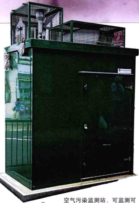
© 空气污染监测站，可监测可吸入颗粒物以及一氧化碳、二氧化氮和二氧化硫等含量
