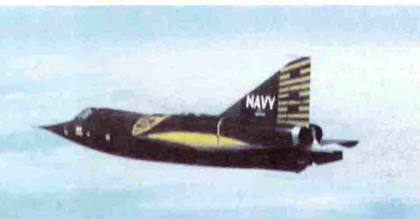
▲ 曾经飞过的最奇怪的飞机之一，这架康维尔公司的XF2Y“海标枪”飞机是一架能在水面上起飞和着陆的马赫数为1的战斗机。
