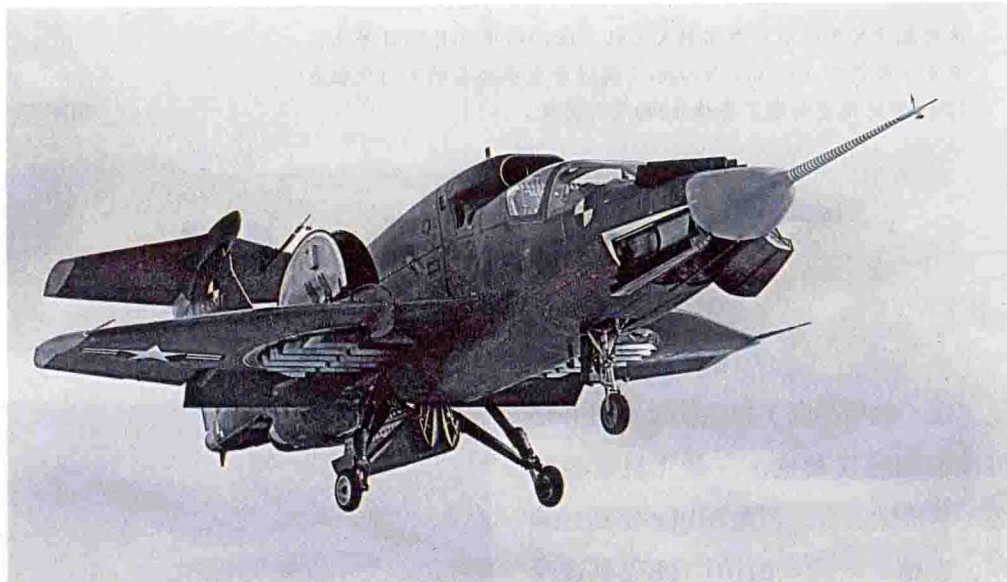
▲ 作为直升机能力与喷气战斗机性能的组合体，这架赖安（Ryan）公司的XV-5A“Vertifan”飞机展示了其巨大的潜力。
