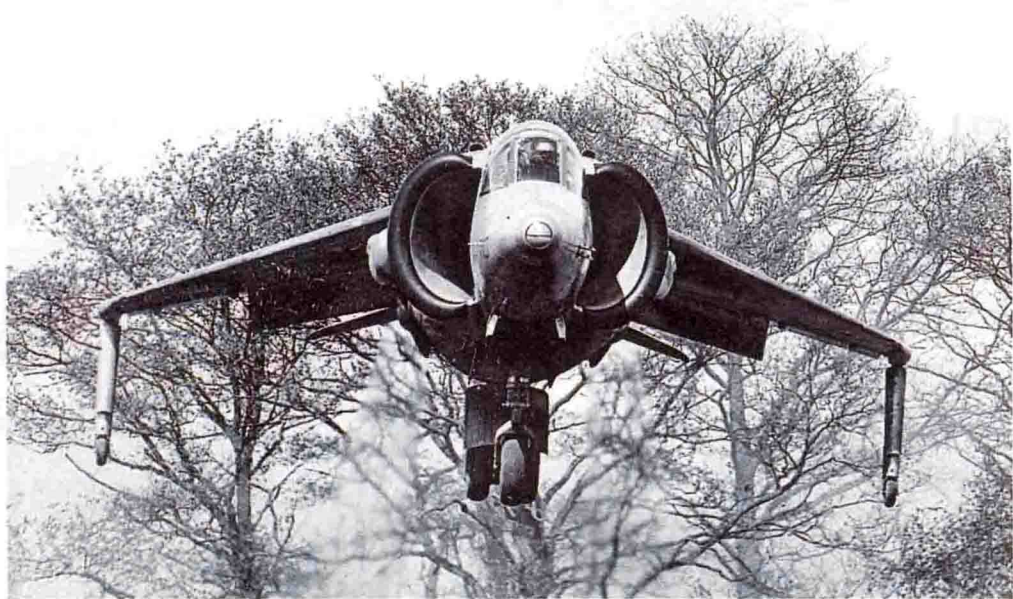
▲ 带有矢量推力的霍克P.1127“红隼”（Kestrel）飞机——“鹞”式飞机的前身。
