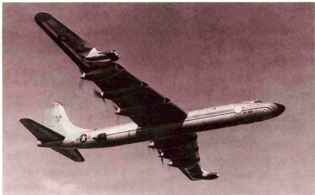
▲ 康维尔公司的NB-36H飞机被建造用来试验在核动力飞机后面的技术，其需要为机组成员提供数吨的铅作为防护屏蔽。
