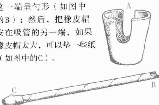
将吸管置于纸杯的杯口（与杯沿齐平），将粗针依次穿过杯子、吸管（如图中的E），将橡皮帽拔出一点儿，使吸管呈勺形的一端微微上翘。
