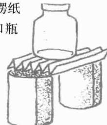
隔10厘米，把刚才折好的瓦楞纸架在这2个纸筒上，再把广口瓶放在瓦楞纸上。
