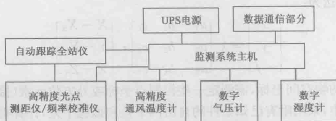
图 1-2 变形测量机器人系统
