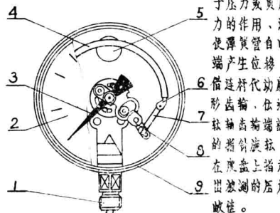
1 接头 2 度板 3 指针 4 弹簧管 5 安全塞 6 封口塞子 7 连杆 8 齿轮传动机构 9 表壳
