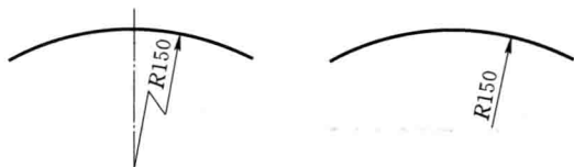
图 1-17 大圆弧半径标注
