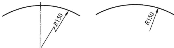
图 1-13 大圆弧半径的标注方法
