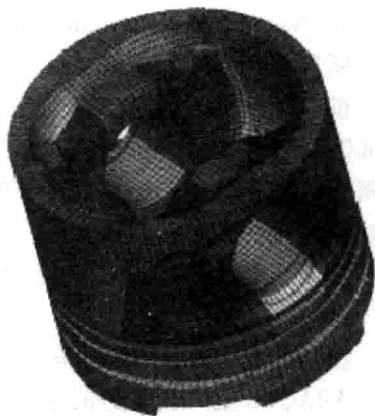
图 1-10 在 ANSA 中完成的 活塞体网格模型
