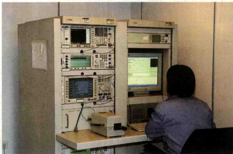
无线终端部 CDMA 射频测试
