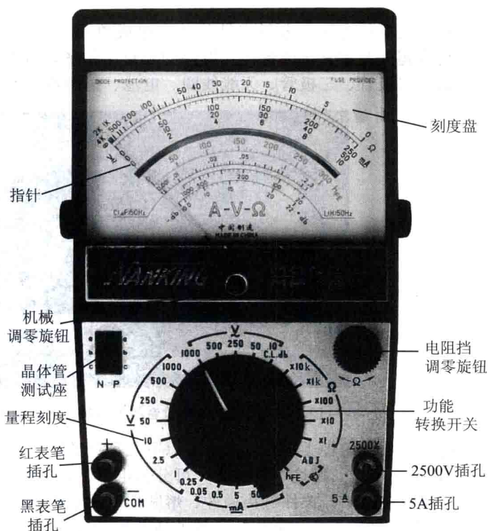
图 1.2 MF-47 型指针式万用表结构图
