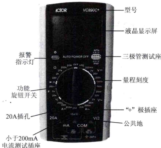
图 1.6 VC890C 数字万用表结构图
