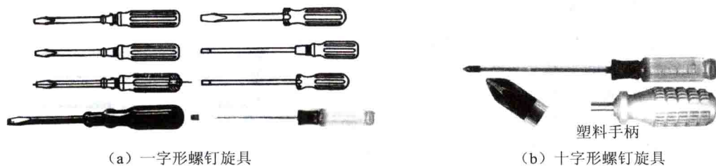
图 1.7 常用的手动螺钉旋具外形结构图
