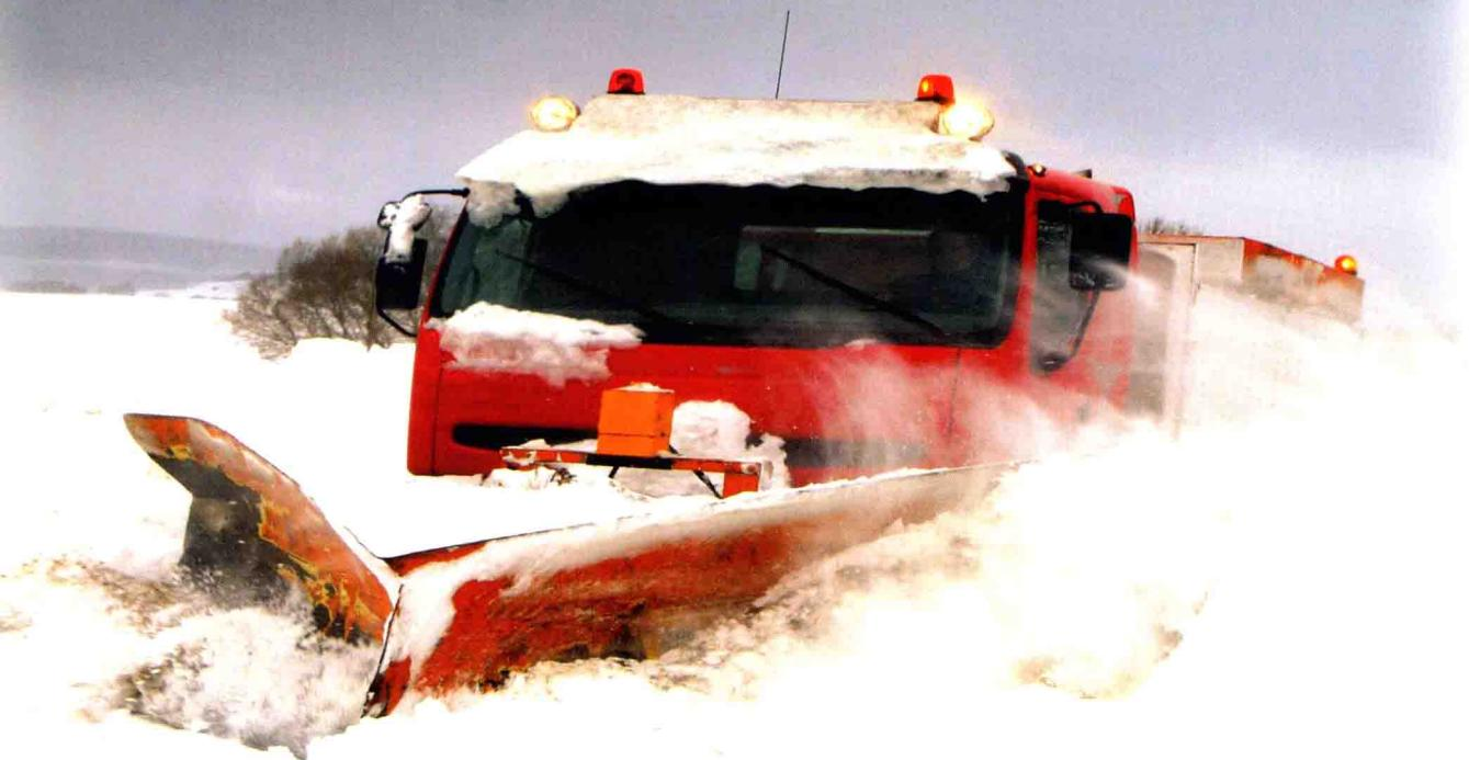
扫雪机的扫雪部分是一种简单的机械。实际上它是由两个楔子构成的。
