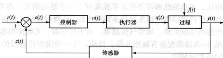
图 1.1.2 典型单闭环负反馈控制系统框图
