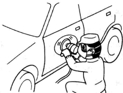
图1-8 用单作用打磨机清除涂料
