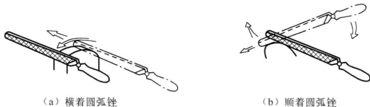
图 1-9 外圆弧面的锉削方法
