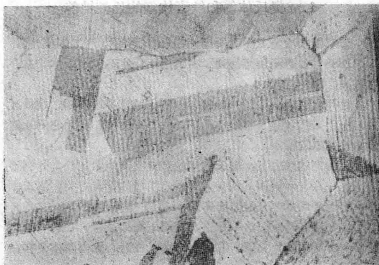
圖1 5H69 鋼淬火和在 800° 1 小时时效后用塑性壓縮所引起的滑移变形。×300
