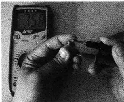
图 1-5 大阻值固定电阻的错误测量
