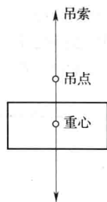
图 1—7 长方形构件 吊装方法
