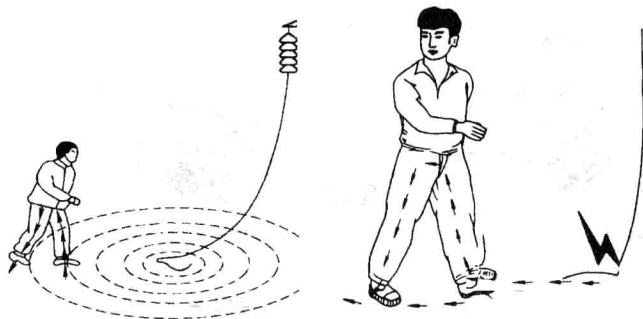
图 1-3 跨步电压触电
