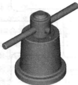
图 1-5 几个简单特征构成的复杂零件
