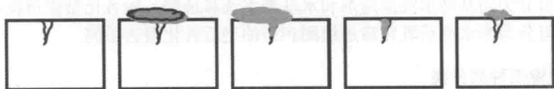
图 1.1 渗透检测的基本原理
