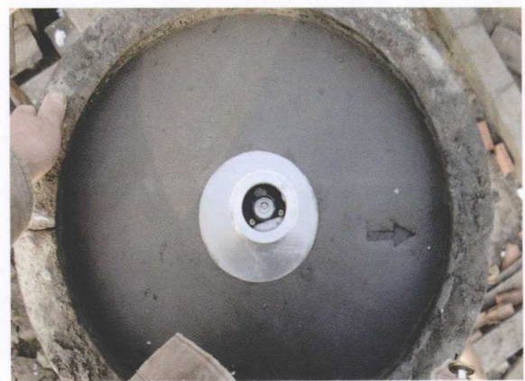
08 GNSS 观测墩强制归心装置平情况
