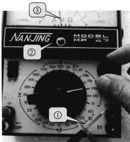
图 1-6 零欧姆调整钮示意图
