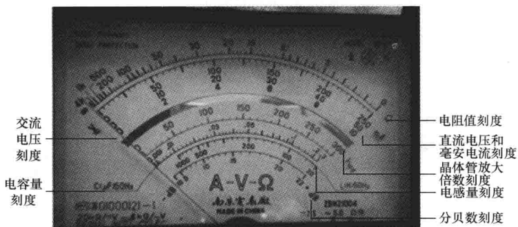
图 1-4 指针式万用表的刻度盘
