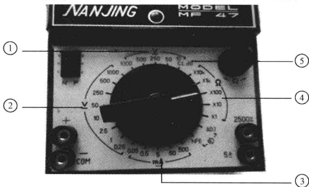
图 1-8 功能旋钮功能及测量范围
