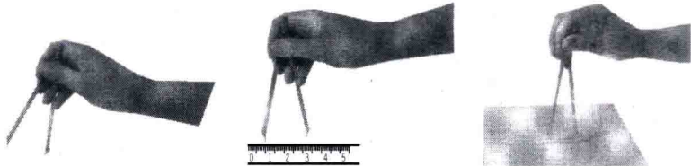
(a)分规的松紧要适中 (b)用分规量取尺寸 (c)用分规等分线段
