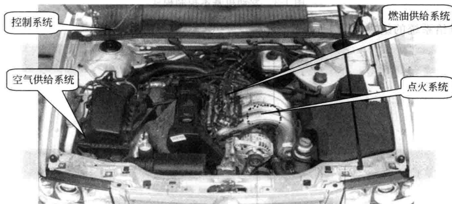
图 1-1 发动机电控系统的总体结构
