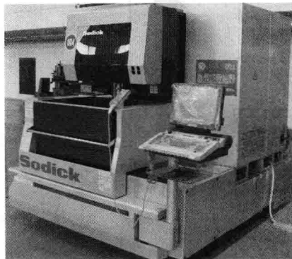
图 1-7 数控线切割机 (慢走丝)
