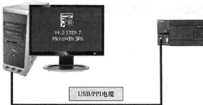
图 1-11 USB/PPI 电缆硬件连接
