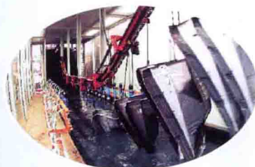
恒融公司汽车涂装厂阴极电泳线
