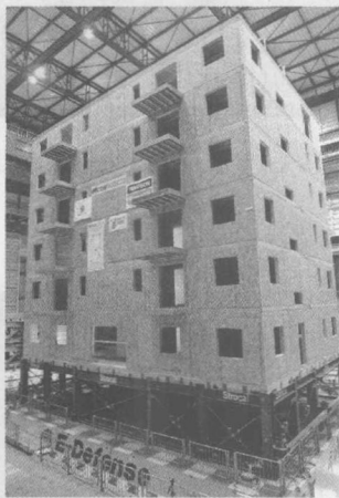
图 1-1-1 日本 E-Defense 振动台七层木结构房屋原型试验 [11]
