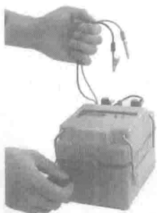
图 1-1-11 绝缘电阻表开路检验
