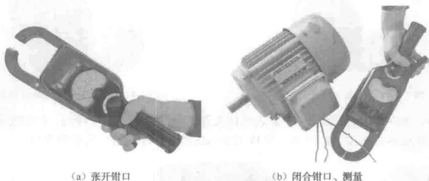
图 1-1-15 钳形电流表测量电动机绕组电流
