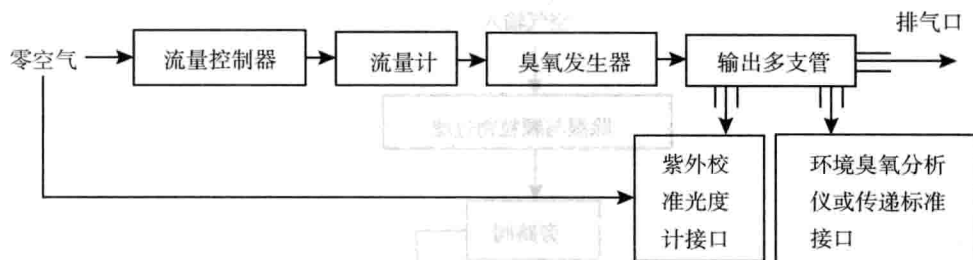
图 2-2 臭氧校准系统气路示意图
