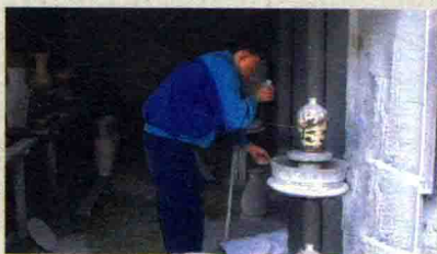
青花瓷的制作 往绘制好图案的素胎土喷制釉
