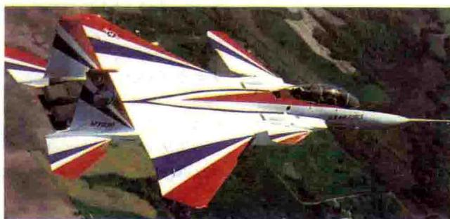
◆ 借助于S/MTD飞机上采用的技术，像F-15这样的大型战斗机就可以与像F-16这样的轻型机灵敏性好的战斗机进行空战。新型的F-22飞机也采用了推力矢量技术。
