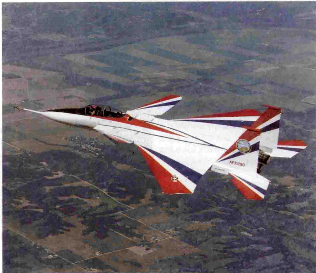
主要用于开发能从受损的跑道上起飞的技术，麦克唐纳·道格拉斯公司的F-15S/MTD飞机（STOL和机动技术验证机）是一种热点作战战斗机（在“沙漠风暴”行动中攻击敌人）的衍生飞机。
