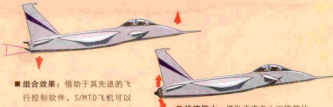
■ **组合效果：**借助于其先进的飞行控制软件，S/MTD飞机可以协同鸭式前置翼面提供向上的力，水平尾翼和喷管提供向下的力，来完成飞机的机动。
