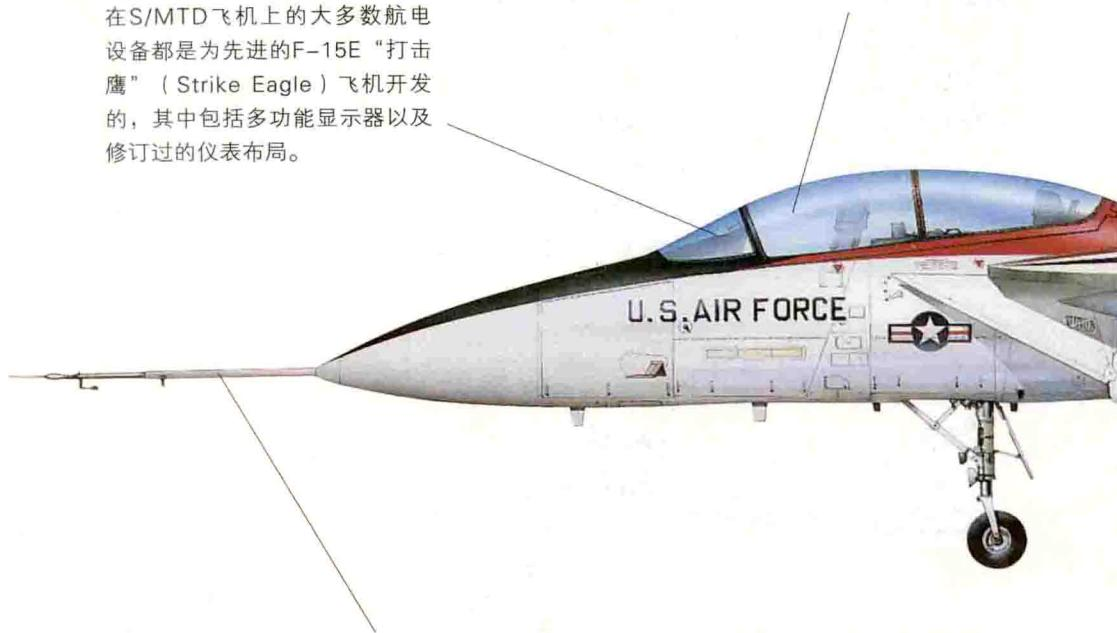
为了帮助精确测量数据，S/MTD飞机在机头上安装了一个突出的空速管。这样就可以获得该机复杂的遥测装置取得精确的读数。
