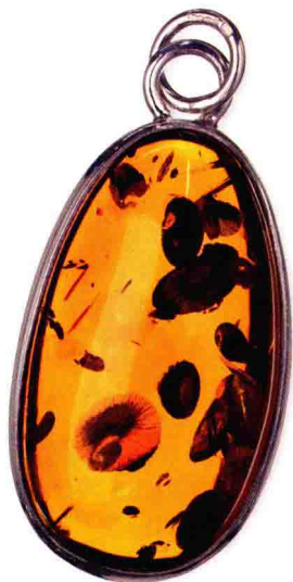
（下）图 9：具有星芒状圆形裂隙的吊坠。这些裂隙在珠宝中很常见，是琥珀在加热过程中形成的（整体长度 60 mm）
