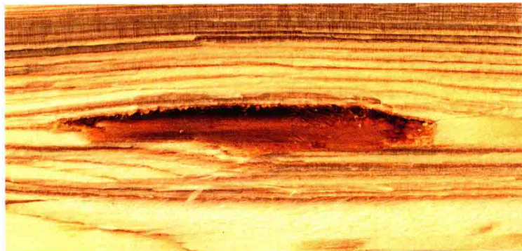
（左）图4：松木局部，内部具有树脂填充的空腔（树脂部分长度 52 mm）
