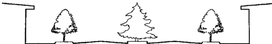
图1-4 二板三带式道路绿地断面图
