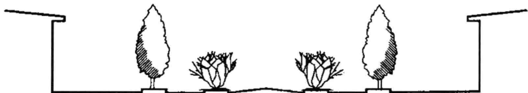
图1-5 三板四带式道路绿地断面图
