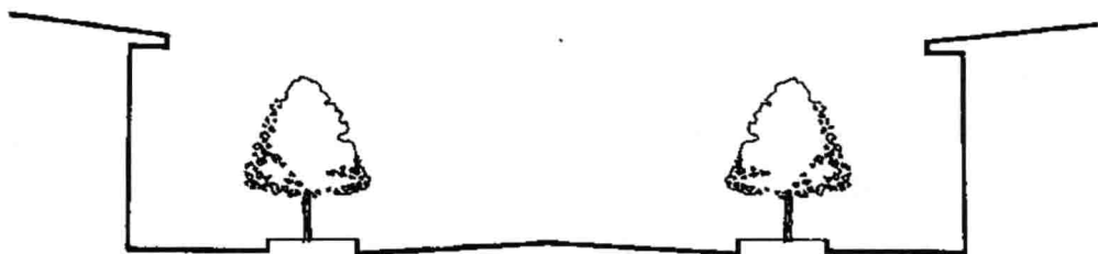
图1-3 一板二带式道路绿地断面图
