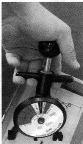
图 1-7 OTC6673 皮带轮张紧计
