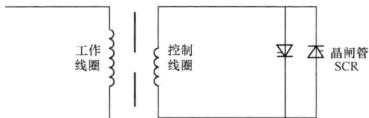
图 1-2 变压器式可控电抗器基本结构
