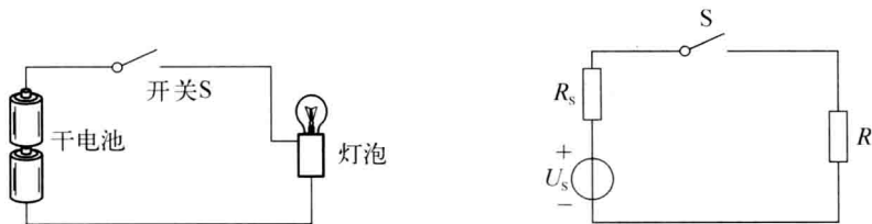
图 1.3 手电筒电路的实际电路与电路模型
