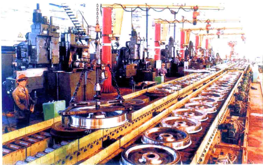
1964年7月29日，我国第一个直径840毫米辗钢整体车轮在马鞍山钢铁公司车轮轮箍厂成功轧制，结束了我国车轮轮箍长期依赖进口的历史。图为车轮轮箍生产线
