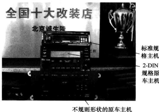
图 1-4 标准规格、2-DIN 规格、不规则形状的原车主机
