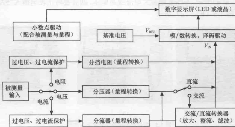
图 1-3 数字型万用表的组成框图
