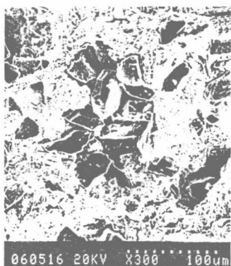
图 1 搅拌 5 min 时成团和分散的 SiC 粒子(SEM)
