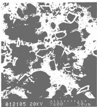
图 2 搅拌 25 min 时 SiC 粒子的分布
