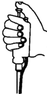
图 1-2 微量移液器握持方法
