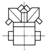
图 1-4 多辊轧法 轧制 T 型钢
