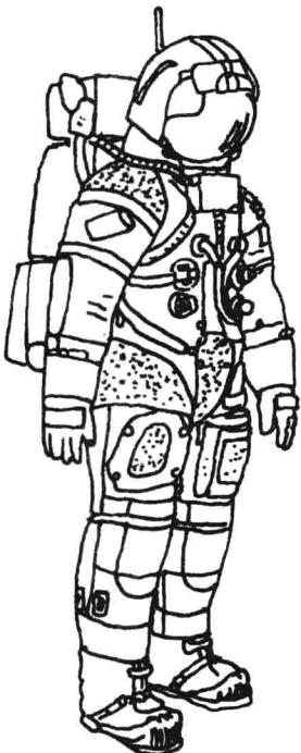
宇航服是由哪些部分构成的呢?它在结构上分为6层:第1层是宇航员贴身的内衣。由于宇航员在长期飞行过程中不能换洗衣服,大量的皮脂和汗液会污染内衣,所以内衣是用质地柔软、吸湿性和透气性良好的优质棉针织品制作的。第2层是保暖层。它是用保暖性好、热阻大、柔软、质轻的材料,如超细高保暖合成纤维、羊毛制成的,用以保持舒适的温度环境。第3层是通风服和水冷服。用以散发宇航员过高的体热。当人体产热量过大,凭通风服散热,仍不能满足散热要求时,即由水冷服降温。第4层是气密限制层。
