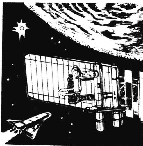
空间站是由运载火箭或航天飞机发射升空的。它一般由对接舱、气闸舱、轨道舱、生活舱、服务舱、专用设备舱和太阳能电池翼等部分组成。对接舱一般有多个对接舱口，可同时停靠多艘载人飞船和其他航天器，乘有宇航员的飞船要与它对接，才能
