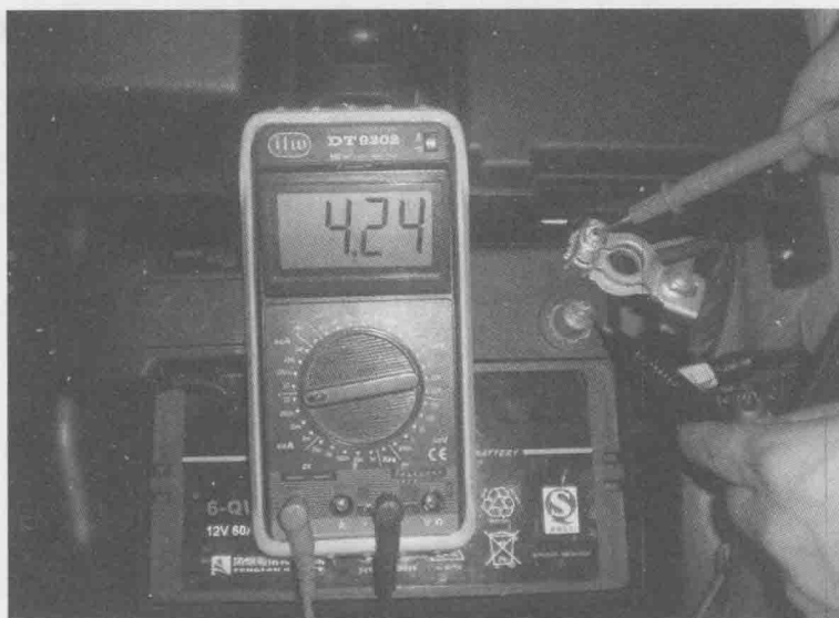
图 1-2-3 检查蓄电池放电电流
